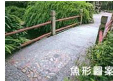
园林道路随建筑、绿化、山石水池的布局曲折绕行，依地形起伏而自由变化。路面花纹的安排和材料的选择，因地段而异。在厅堂门前、亭廊建筑周围、多采用[黄石](#)、青石、卵石、青砖、青瓦、缸片、碗片等多种材料铺成植物、动物等花纹图案；一般道路则用黄石、青石、缸片，铺设花纹线条简单明快。在建筑周围长方规则形地处，选择方形或六角形几何图案；在道路弯曲宽狭不一以及多边自然形地处，选用冰裂纹直线图案，以适应路面曲折变化。花纹图案内容，与周围景观相配合，如梅花厅前后地坪，铺设了梅花形状的图案；在小云兜假山地坪处，铺设“龙”的图案，有[龙云](#)相配意境；在逸野堂四周地坪上铺设冰裂纹，中间嵌以“暗八仙”图案。
